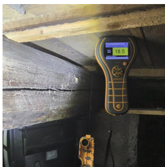
Helhetsvurdering - Eksempel på fuktmåling
