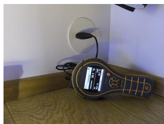
Kontroll i lukkede konstruksjoner - Fuktmåling
