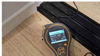
Utført kontroll i tiliggende konstruksjon - Fuktmåling uten forhøyede verdier
