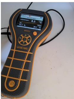
Utført kontroll i tiliggende konstruksjon - Fuktmåling
