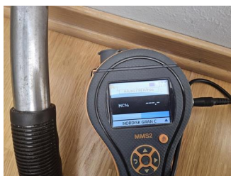
Utført kontroll i tilliggende konstruksjon - Fuktmåling bad via soverom.
