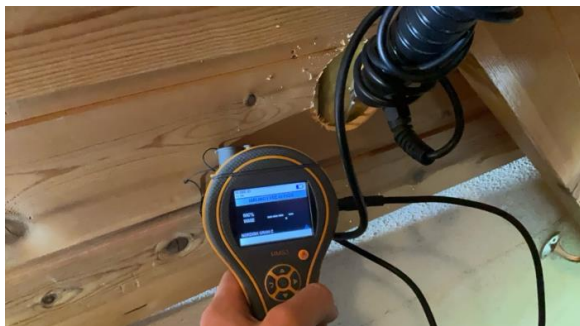
Fuktmåling med pigg mot våtrom: Det ble ikke målt forhøyde fuktverdier ved hulltaking på befaringsstidspunktet.
