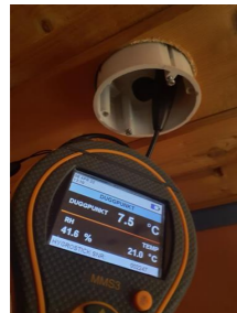
Utført kontroll i tilliggende konstruksjon - Fuktmåling.
