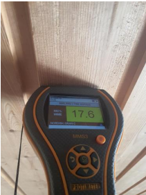
Stikktaking i treverk, fukt og fuktmålinger - Fuktmåling i etasjeskille.
