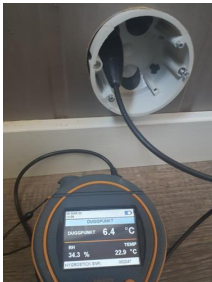
Utført kontroll i tilliggende konstruksjon - Fuktmåling.
