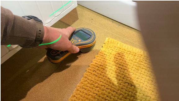
Enkle fuktsøk viste normale verdier.
