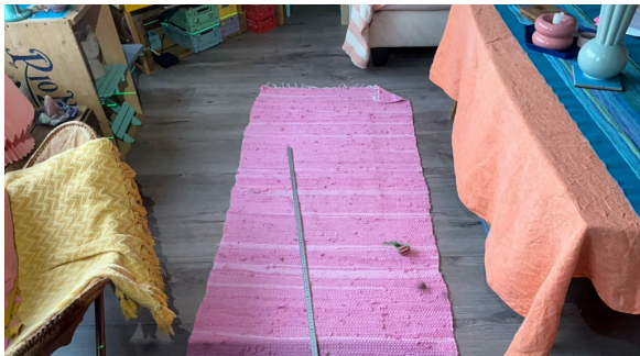
Helningsavvik på ca. 13 mm over en avstand på 2 meter i stueområdet.
