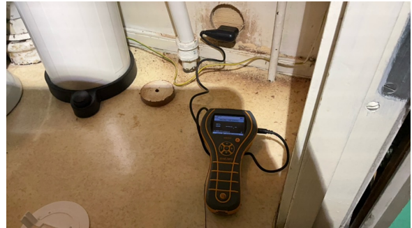
Hulltaking er utført i tilstøtende vegg mot servant/dusj. Veggen er av kompakt trevirke. Fuktmåling viste tørre verdier.
