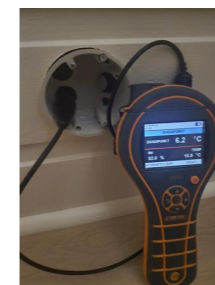
Utført kontroll i tilliggende konstruksjon - Fuktmåling.
