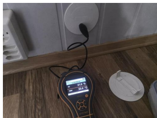
Utført kontroll i tilliggende konstruksjon - Fuktmåling
