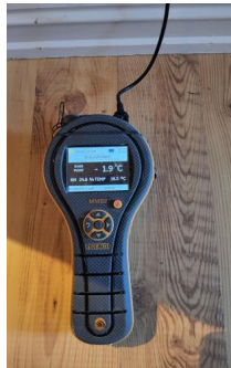
Utført kontroll i tilliggende konstruksjon - Fuktmåling
