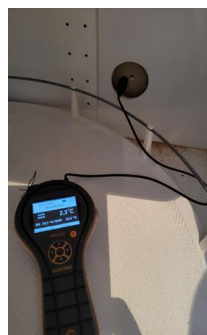
Utført kontroll i tilliggende konstruksjon - Fuktmåling
