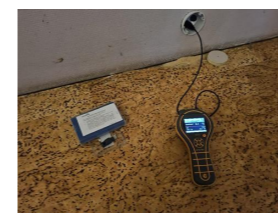
Utført kontroll i tilliggende konstruksjon - Fuktmåling
