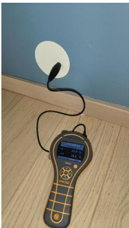
Kontroll i lukkede konstruksjoner - Fuktmåling
