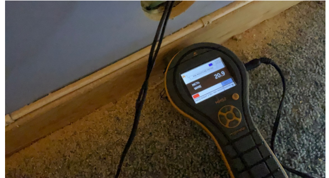
Noe høy fukt/vektprosent i kjeller i soverom utforet kjeller yttervegg
