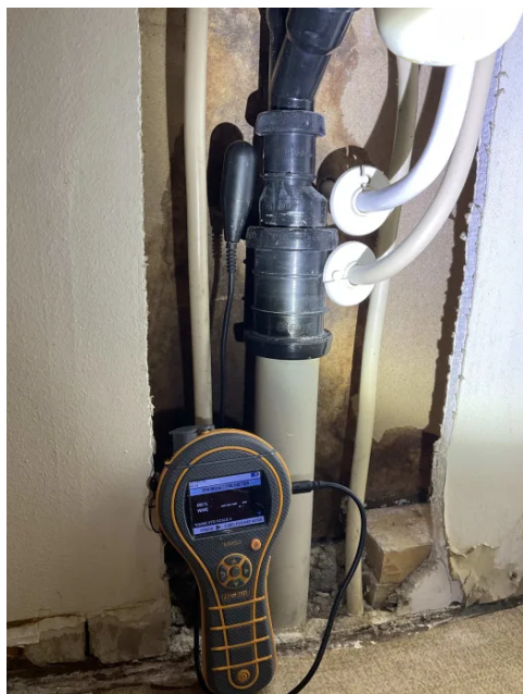
Fuktsøk uten unormale verdier, ingen tegn til restfukt
