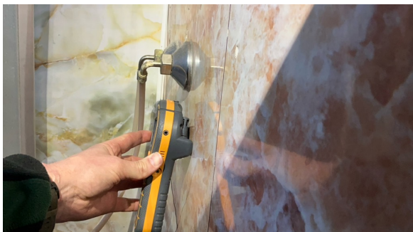
Enkle fuktsøk viste normale verdier.
