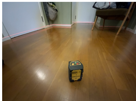
Høydeforskjeller er målt med laser i utvalgte rom.
