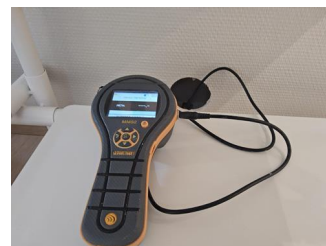
Utført kontroll i tilliggende konstruksjon - Fuktmåling.
