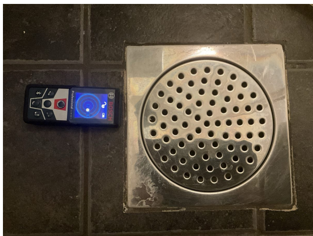
Foto 4: Måling av fall til sluk.
