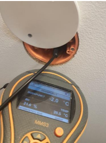
Utført kontroll i tilliggende konstruksjon - Fuktmåling i etasjeskille mot våtsone gulv.
