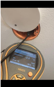
Utført kontroll i tiliggende konstruksjon - Fuktmåling i etasjeskille mot våtsone gulv.
