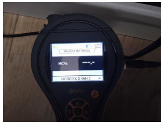
Utført kontroll i tiliggende konstruksjon - Fuktmåling bad 2.etg.
