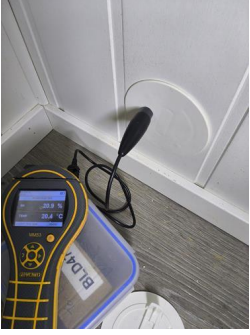
Utført kontroll i tilleggende konstruksjon - Fuktmåling
