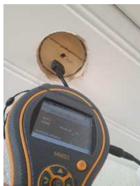
Utført kontroll i tilliggende konstruksjon - Fuktmåling i etasjeskille mot våtsone gulv bad loftsetasje
