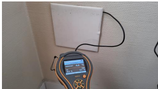
Utført kontroll i tilliggende konstruksjon - Fuktmåling veggkonstruksjon bad og vaskerom 1.etg
