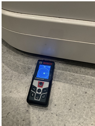
Foto 2: Målt fall i forkant av dusjkabinett
