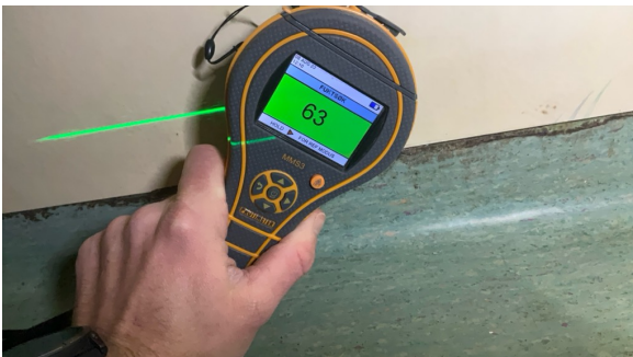
Vegg: Ved bruk av fuktindikator på utsatte steder registrerte jeg ikke forhøyde verdier.
