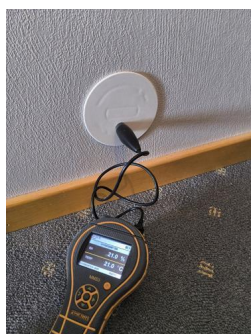
Utført kontroll i tilliggende konstruksjon - Fuktmåling
