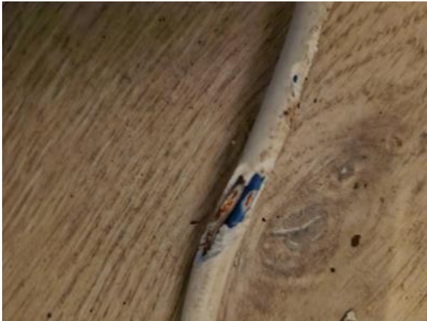
Gnag helt inn på ledere. Ledning byttet
