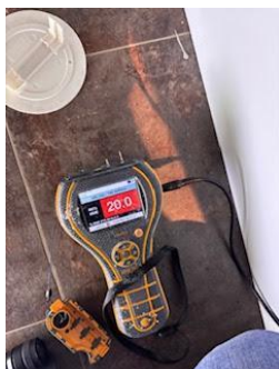
Kontroll i lukkede konstruksjoner - Fuktmåling i vegg i underetasjen.
