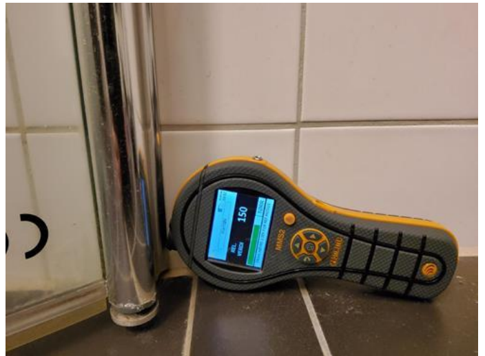
Kommentar - [Fuktsøk bad.]
