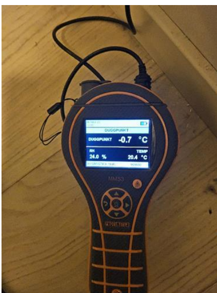
Våtrom - [Fuktmåling ifm bad.]
