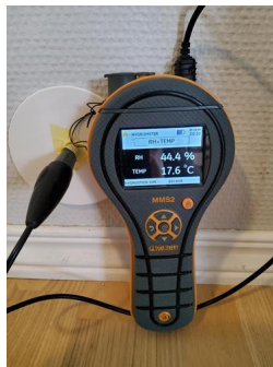
Utført kontroll i tilliggende konstruksjon - Fuktmåling bad
