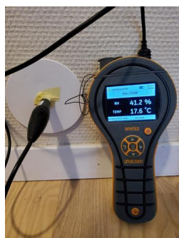
Utført kontroll i tilliggende konstruksjon - Fuktmåling bad 2.etg.
