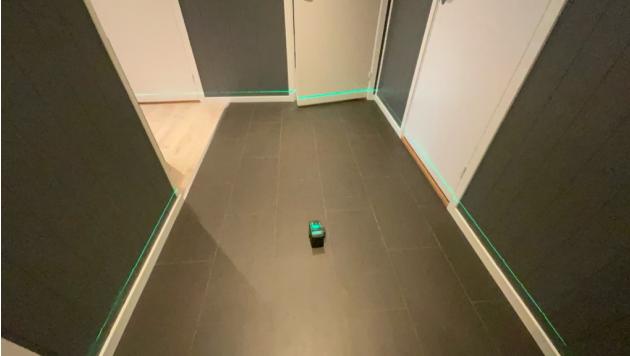
Måling av eventuelt retningsavvik.
