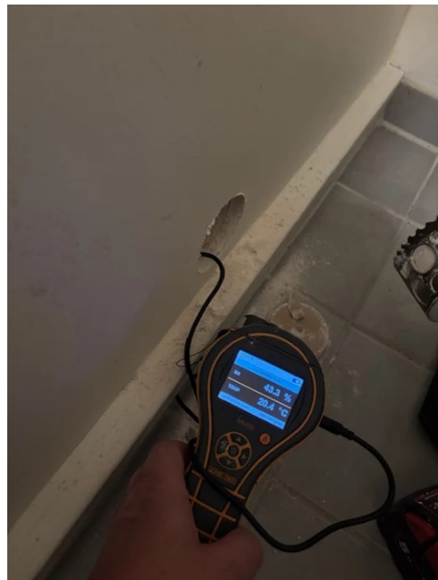
Hulltaking med fuktmåling mot våtsone uten avvik målt fra tiliggende bod.
