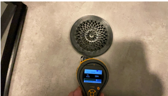
Fuktsøk er utført på gulv ved sluk. Ingen forhøyde fuktavvik er målt
