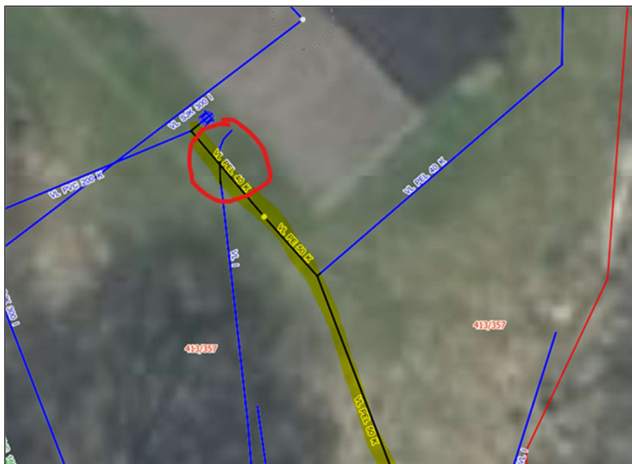
Figur 7: Et mindre strekke av vannledningen har dimensjon 40 mm. Antatt/estimert ca. 3 meter.
