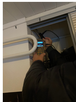
Fuktsøk på ene rommet i 2 etasje = ok, med fuktmerker langs pipe
