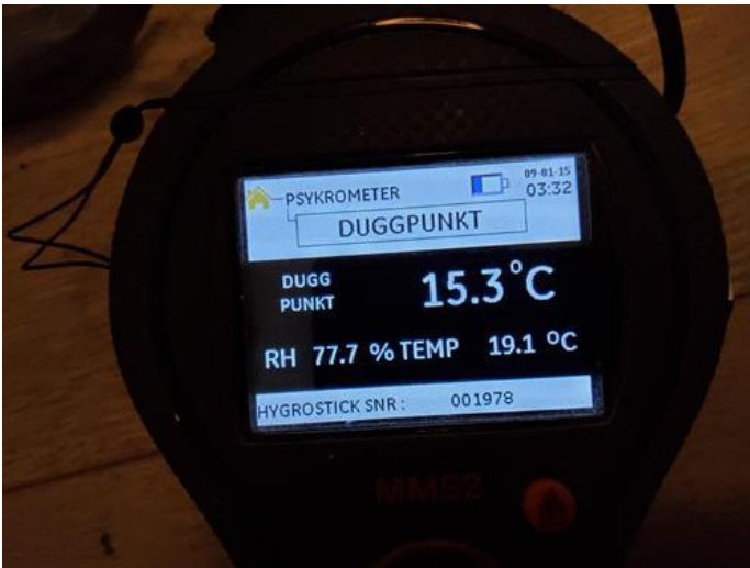
Konstruksjoner (tilfarergulv, himling og vegger). - [Fuktmåling 1.etasje]
