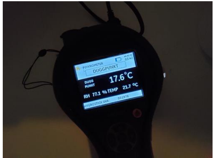
Fukt i tilliggende konstruksjoner - [Fuktmåling]
