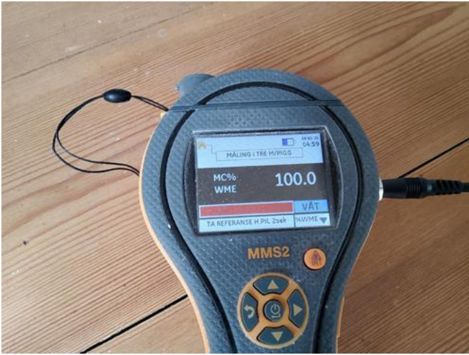
Konstruksjoner (tilfargerulv, himling og vegger). - [Fuktmåling i hybel ]
