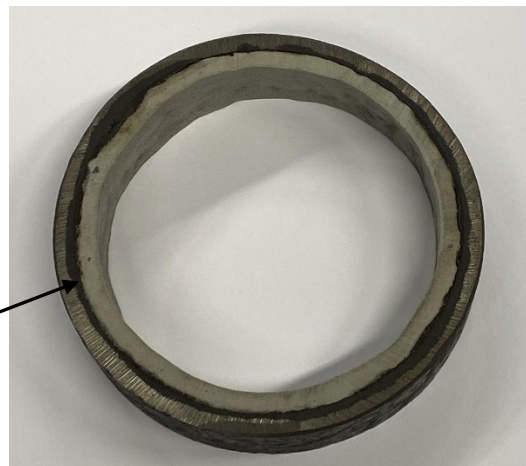
Forsegle mellom nytt og gammelt rør
