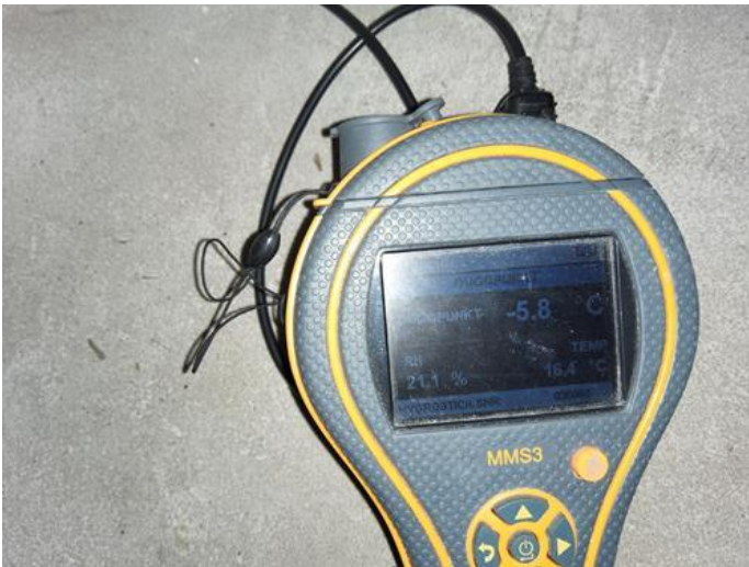
Fukt i tilliggende konstruksjoner - [Fuktmåling bad]
