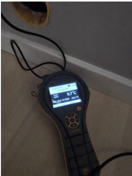
Fukt i tilliggende konstruksjoner - [Fuktmåling bad ]
