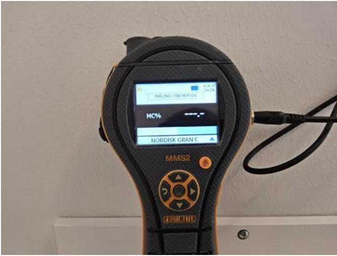
Våtrom - [Fuktmåling bad.]
