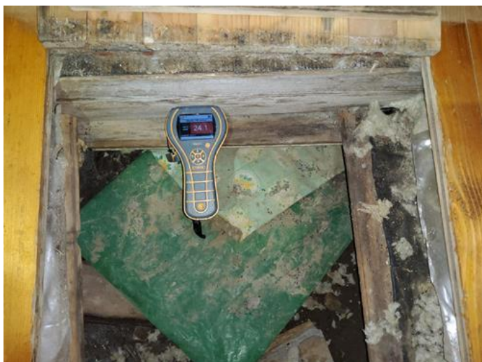
Helhetsvurdering - [Fuktmåling bjelkelag krypekjeller]
