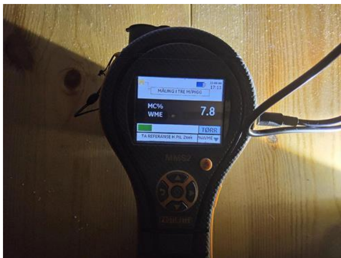
Våtrom - [Fuktmåling bad nr 2.]
