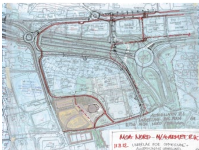
Figur 228 – Alternativ løsning for rundkjøring i Breivika med fire armer i stedet for fem.
