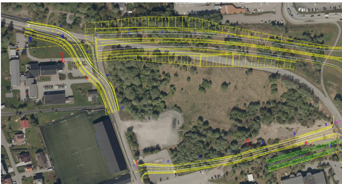
Figur 2: Midlertidig omlegging av Moavegen
