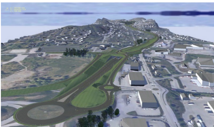
Figur 38 - I øst går vegen i skjæring fra rundkjøringa i Breivika til den går inn i betongtunnelen.
