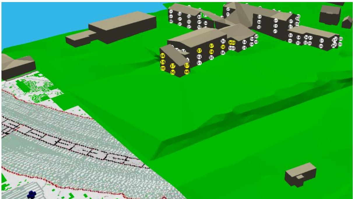
Figur 6: Beregning ekvivalent støynivå L_{pAeq} på dagtid – Byggefase. Støybidrag fra gravemaskin i drift på kote 45
