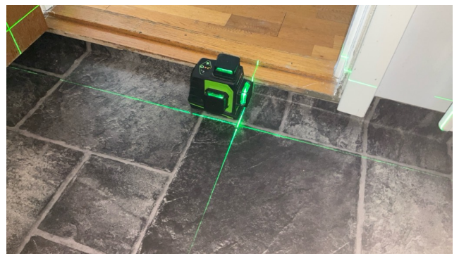
oppbrett på belegg ved terskel som er bra
