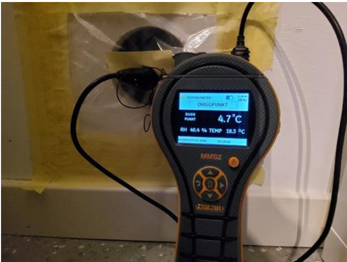
Kommentar - [Fuktmåling bad.]
