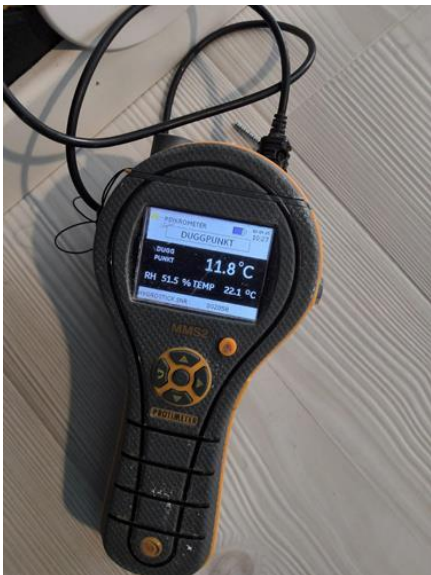
Fukt i tilliggende konstruksjoner - [Fuktmåling]
