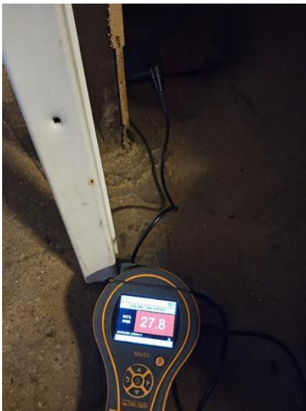
Rom under terreng (kjeller, underetasje, sokkeletasje) - [Fuktmåling hytte nr. 74 ved gulv.]
