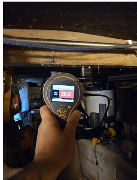
Rom under terreng (kjeller, underetasje, sokkeletasje) - [Fuktmåling hytte nr. 74 ved takbjelke.]
